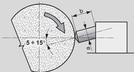
Je nutné dodržovat doporučenou hloubku řezu ( $0,025 \div 0,03$  mm). Větší hloubky řezu vyvolávají přehřátí diamantu a jeho rychlejší opotřebování. Posuv do  $0,2$  mm/ot..
