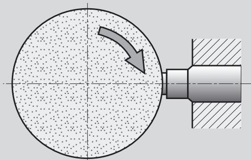
Chladičící kapalinu nasměrovat na čelo orovnávače a přivádět ji již před započetím orovnávaní.
